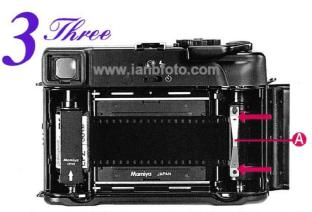
必ずフィルム押さえローラー板 <a>↑</a> を矢印の方向に引いて裏ぶたを閉じます。
