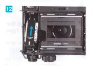
3. 巻き戻しクランクが軽くなったら、裏 ぶたを開けてパトローネを取り出します。 裏ぶたを開いたとき S (スタート) に自動復元します。
